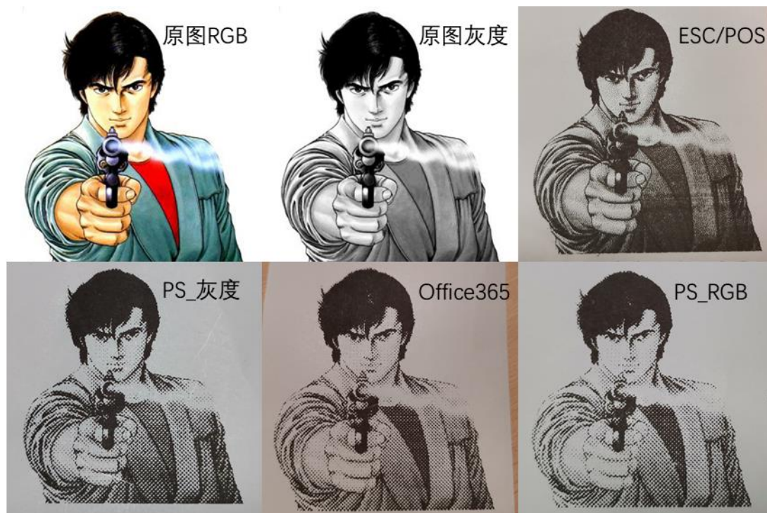
图 8 不同打印方式的打印效果对比。
