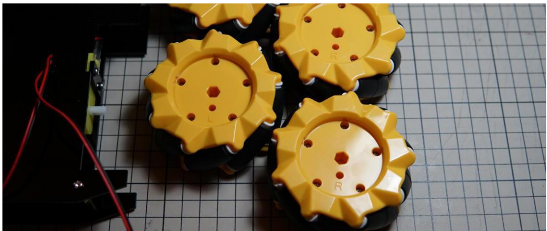
8、注意麦克纳姆轮是有方向的。在背面有写 L 和 R 字样。左前轮与右后轮是 L，右前轮与左后轮是 R。（请确保方向与下图一致）用联轴器器和尖头自攻螺丝固定在电机轴上。
