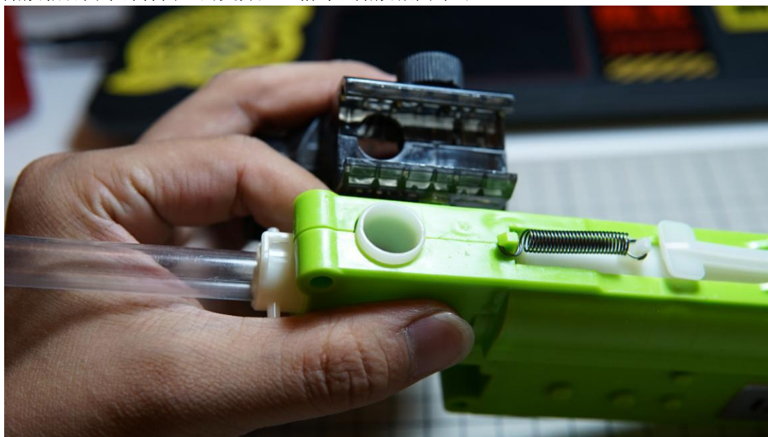
9、安装武器部分，弹仓的出弹口要与波箱的进弹口吻合在同轴心内。用手按住，然后用热熔胶粘合两个部件两边的交界处。稍等热熔胶凝固即可。
