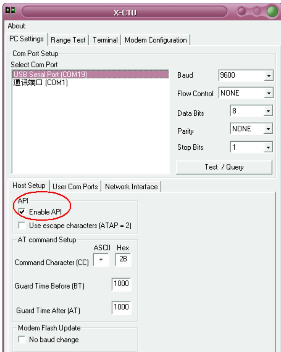
点击 modem configuration 标签。点击 Read，读取模块信息。读取完毕后，在 function set 下拉列表框里选 ZIGBEE COORDINATOR API，其他参数默认。点击 Write
