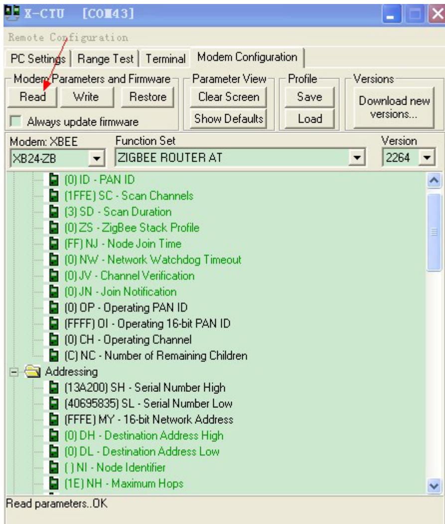
本次组网配置后最终的效果是：A、B、C三个模块两两之间可以互相发送信息。例如：A模块发送指令给B，B能接收显示A发送过来的信息内容。A指令的主要内容包括：B模块的地址、要发给B模块的信息内容。其他模块两两之间也如此。下面开始配置模块：
